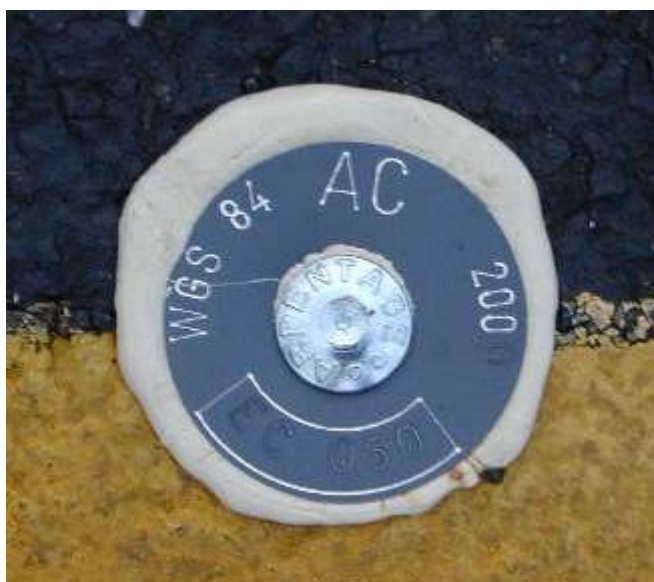
Clou d'arpentage et plaque d'identification
